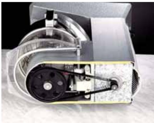
La trasmissione a cinghia con frizione garantisce affidabilità anche al massimo carico
